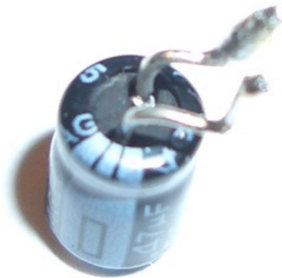
Abb. 38 Lötzinn an den Kondensator Beinchen aufgebracht
