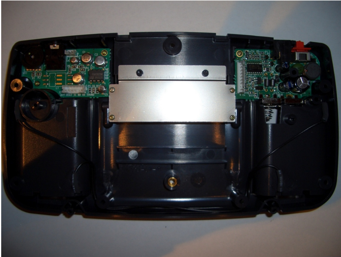
Abb. 18 Ausbau Netzteilplatine japanisches Modell
