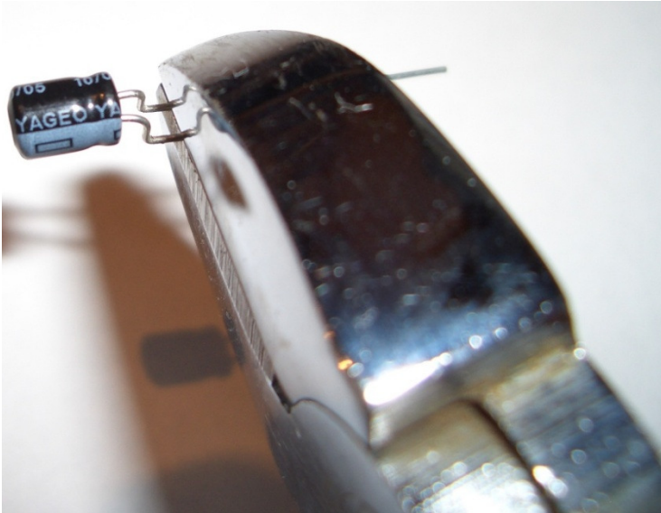
Abb. 36 Kondensatordrähte mit dem Seitenschneider abschneiden
