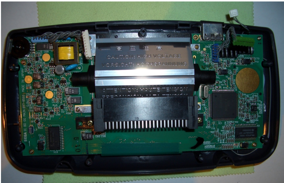
Abb. 27 Hauptplatine mit Gehäuse auf Microfasertuch
