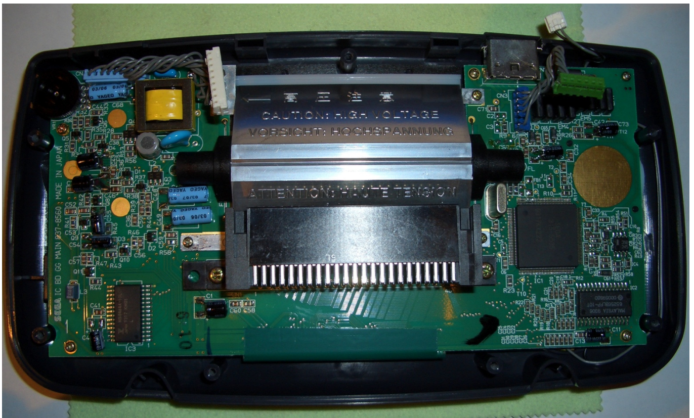
Abb. 40 Hauptplatine mit komplett erneuerten Kondensatoren
